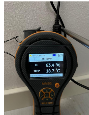
Måling av relativ luftfuktighet.
